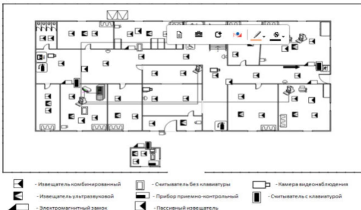
При разработке схемы расположения средств подсистемы обнаружения необходимо учитывать требования по геометрическим признакам помещений и территорий, а также технические характеристики приборов. Обозначения охранно-пожарного оборудования согласно требованиям рекомендаций РД 78.36.002-99 ГУВО МВД России. Технические средства систем безопасности объектов. Обозначения условные графические. Результаты зафиксировать в отчете.
